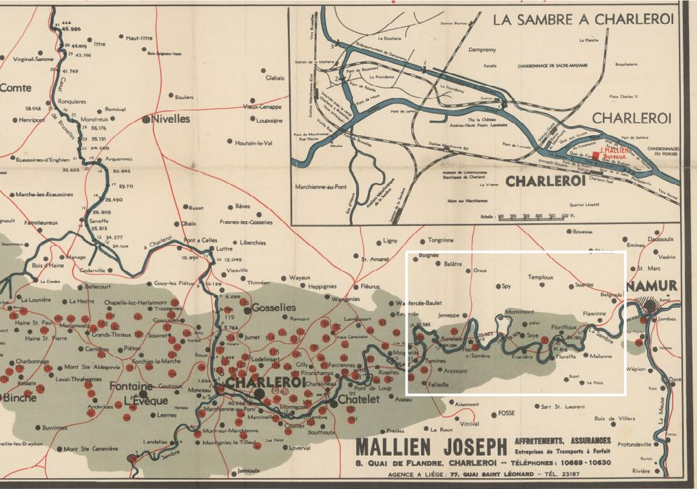
mons et Condé ». Les ● signalent les puits d'extraction et la zone grise, les limites du terrain houiller.
