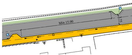
Le cheminement cyclo-piéton sera recouvert d'asphalte de couleur ocre et sera surélevé de 7 à 10 cm par rapport à la voirie. Les chicanes (côté cheminement) seront recouvertes du même asphalte. Pour le côté « champs », il est prévu de remettre les accotements en état avec les matériaux actuels; les chicanes seront engazonnées. Dans le cas des deux habitations (n<sup>os</sup> 40 et 42), l'accotement sera en gravier.
