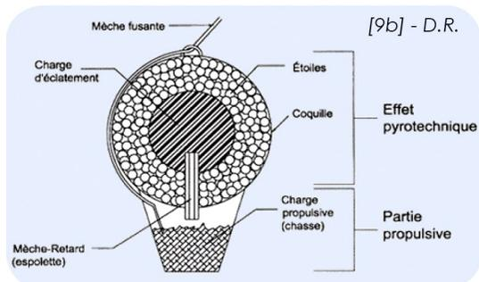
**BOMBE** : artifice tiré à l'aide d'un mortier qui permet la dispersion et l'allumage en altitude
